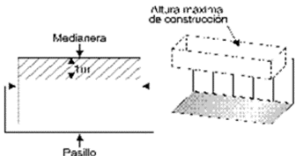
Stand entre 1 medianera El rayado /// indica donde la altura máxima de construcción es 2,5 m
